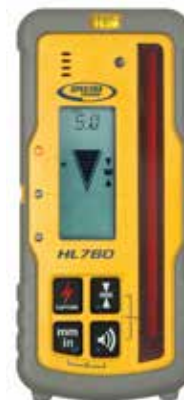
Усовершенствованный приемник с радио и цифровой индикацией HL760 для измерения и отображения положения луча
