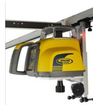
**Примечание.** Во избежание случайных падений проденьте потолочный провод через рукоятку лазера и закрутите провод.
